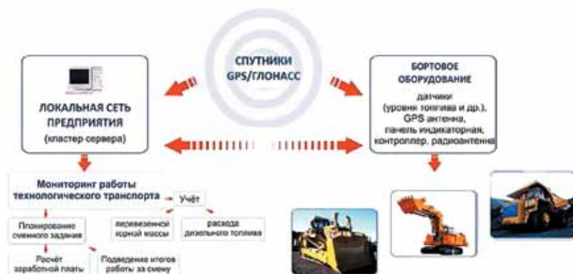
Рис. 1 Схема работы системы диспетчеризации АСД «Карьер»
